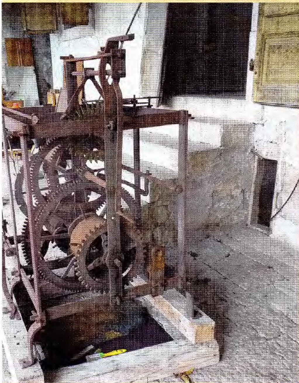
Il meccanismo dell'orologio Solari nel campanile di San Nicola a Pisino
